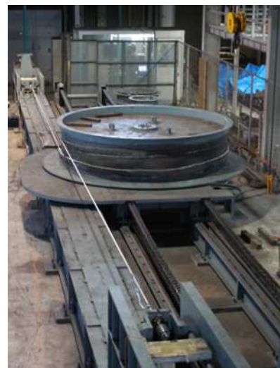
600kN Sheave test machine
